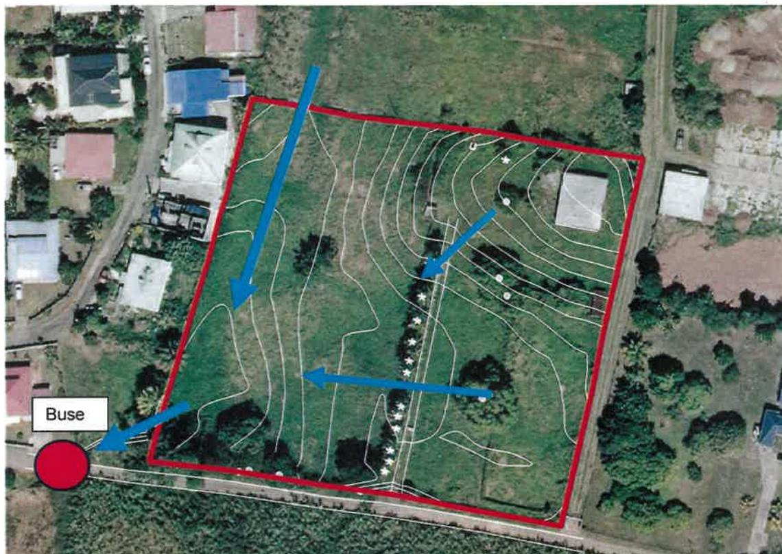
**Figure 6 : principe des écoulements de surface sur l'emprise du projet**
