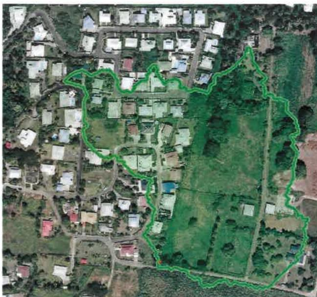
**Figure 2 : bassin versant en amont de la première buse Ø500**
